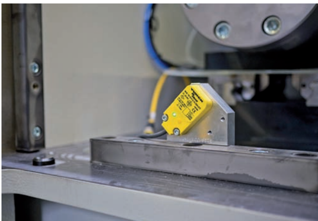
Kirschenhofer si vybral čítaciu/zapisovaciu hlavicu TN-Q14 s ochranou IP67 vďaka svojej kompaktnej konštrukcii.
