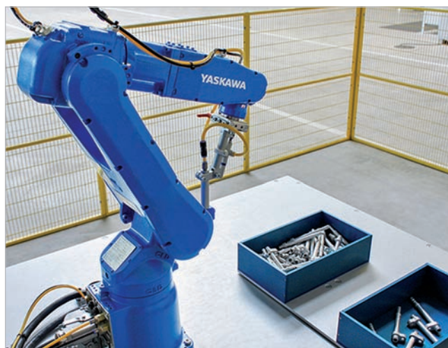
Manipulátor je vybavený špecifickým chápadlom vytvoreným spoločnosťou ASS. (Zdroj: ASS)
