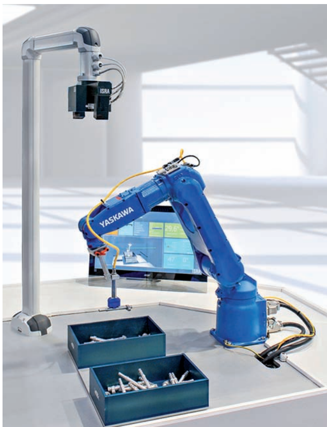
Flexibilné a efektívne riešenie zberu zo zásobníka pomocou robota Motoman MH5LF (Zdroj: ASS)
